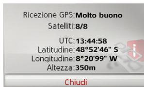
È possibile sapere quanti satelliti vengono ricevuti e se la ricezione satellitare sia sufficiente per la navigazione. Inoltre vengono visualizzate l'ora attuale e la posizione geografica.
