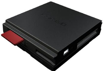
Гнездо для карты памяти находится с правой стороны устройства Becker® MAP PILOT. Отсек для карт снабжен пружинным механизмом фиксации/извлечения.
