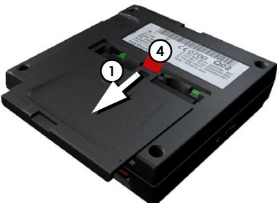
→ Нажать на крышку аккумуляторного отсека в нижней части устройства ① и извлечь ее в направлении стрелки.
