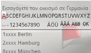
Στην επάνω γραμμή εμφανίζονται οι χαρακτήρες που έχουν εισαχθεί μέσω του μενού εισαγωγής. Η κεντρική περιοχή χρησιμεύει στην εισαγωγή χαρακτήρων. Στην κάτω περιοχή εμφανίζεται, π.χ. στην εισαγωγή μίας τοποθεσίας, μία λίστα των τοποθεσιών που αντιστοιχούν στην τρέχουσα εισαγωγή.
