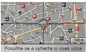
→ Nyní můžete otáčením otočného tlakového ovladače vybrat koncový bod blokovaného úseku.
