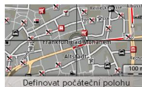
→ Otáčením otočného tlakového ovladače můžete vybrat počáteční bod blokovaného úseku.
